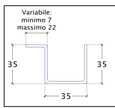
Profilato a produzione standard Misura base fissa come da disegno Misura altezza fissa come da disegno Misura aletta variabile
