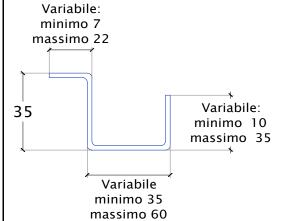
Profilato a produzione con modifica attrezzatura Misura base variabile a richiesta Misura altezza fissa come da disegno Misura aletta variabile
