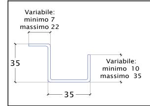
Profilato a produzione standard Misura base fissa come da disegno Misura altezza fissa come da disegno Misura aletta variabile Misura lato senza aletta variabile
