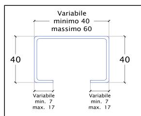
Profilato a produzione con modifica attrezzatura Misura base variabile a richiesta Misura altezza fissa come da disegno Misura alette variabili e possibilità di misura diversa fra loro
