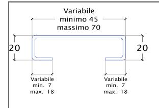
Profilato a produzione con modifica attrezzatura Misura base variabile a richiesta Misura altezza fissa come da disegno Misura alette variabili e possibilità di misura diversa fra loro
